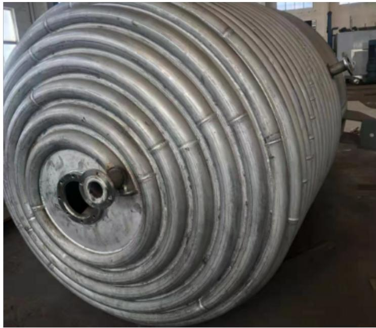
外盘管及其弯圆都是根据钢带折弯成形的。在它的生产过程中有以下几个点：1、原材料：要选择合适的材料。2、生产加工原材料：将原材料开展剪裁成大小合适的钢条。3、外盘管的压圆：将钢带放进折弯机后，先压出来半圆形。4、折弯：在压出来半圆形后，对其进行折弯，注意这个过程要时刻准确测量校正。5、电焊焊接：当钢条的长短不足，可在一根钢条完毕前使用电焊焊接下一根钢条，从而保障持续性。6、校正：对每个主要参数进行调节校正。以上就是外盘管的主要的几个生产过程。无锡日之尧科技的弯管物美价优，有想法的都可以来咨询！泰州盘管价格
