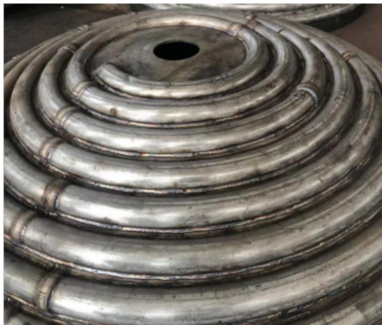
目前，不锈钢盘管发展迅速，应用非常广，涉及的领域非常广，给我们的生活、生产带来很多帮助和便利。这和它的优点是分不开的，下面就让小编来分析一下作用。不锈钢盘管耐高温蒸汽、抗冲击腐蚀、耐氨腐蚀；抗结垢、不容易沾污、抗氧化腐蚀；使用寿命长、减少维修保养时间，节省费用；装管工艺性好、可直接换管，安全可靠；不锈钢盘管的管壁均匀、壁厚只有钢管的50-70%，总体导热系数优于钢管；是老机组改造和制造新设备的理想换热产品之一；目前已经在石油化工、电力、核工业、医药、食品等行业可普遍使用。泰州盘管价格无锡日之尧科技可供应各类弯管，请放心合作。
